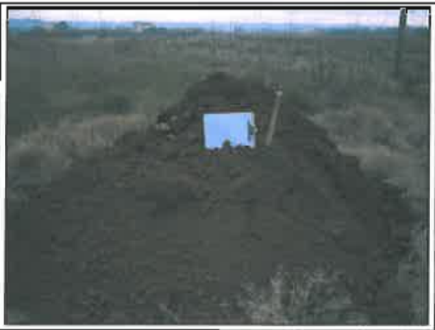
FOTO 5: Acopios de la calicata mecánica nº 2.
