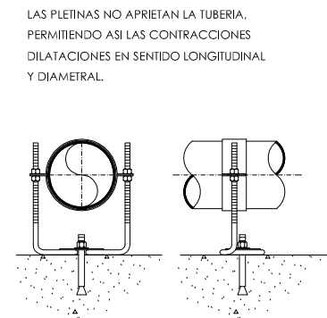
SOPORTE GUIA O DESLIZANTE DETALLES C
